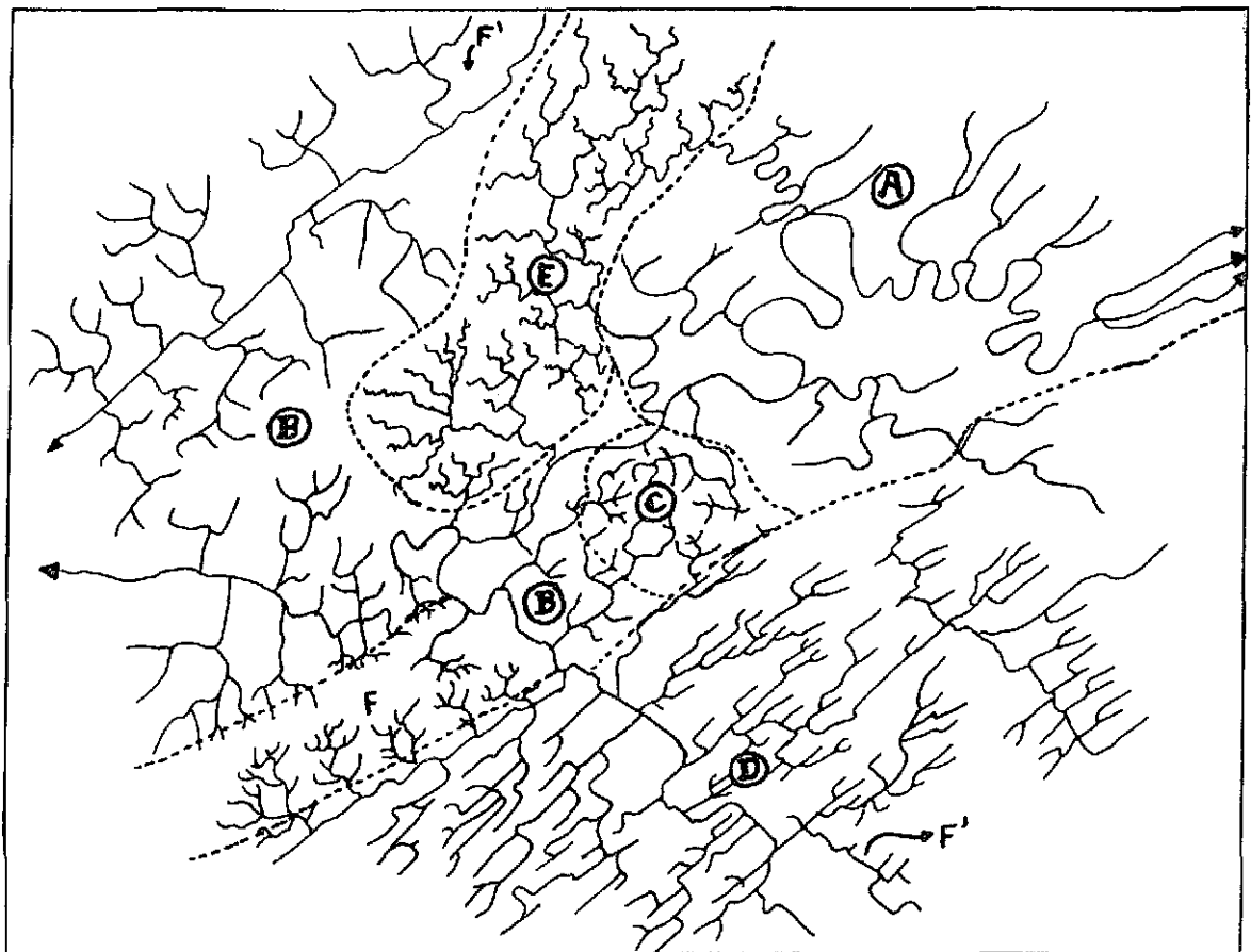
Fig.IV.9 - Modelo fotointerpretativo da rede de drenagem.
